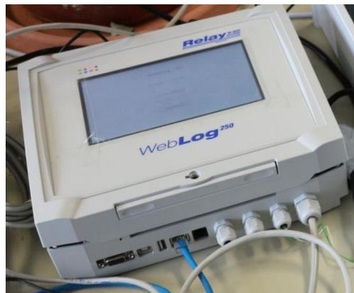
**Bild 6** Schaltkasten Relay Weblog 250
