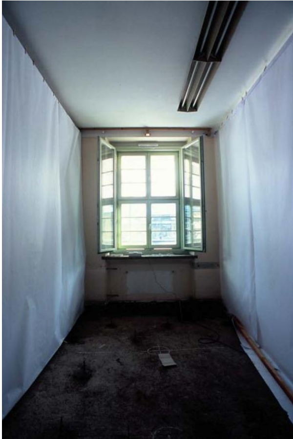
Außenfenster oben: Lichtlenkglas "Okasolar W"; unten: Electrochromes Glas;
