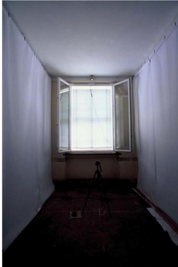
Außen- und Innenfenster: Zweifach Wärmeschutzverglasung; Tageslichtsystem: Lamellenraffstore: Warema Genius E 50 (weiß)
